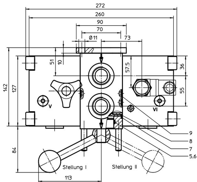
Stellung I: Linke Filterseite in Betrieb
