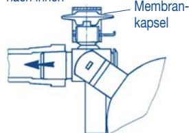
Verzögerungsfrei reagierende Anfahrt und Dauerentlüftung mit hoher Entlüftungsleistung. Besonders geeignet zur Entlüftung vorgeschalteter Heizflächen. Eine in der Membrankapsel eingeschlossene Spezialflüssigkeit verdampft und kondensiert nahe Siedetemperatur, wodurch das Ventil öffnet oder schließt.
