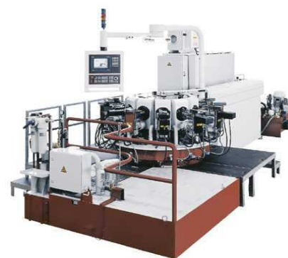
Machines Transfert - Transfert Maschinen
